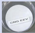
天然ガス自動車の排出ガスを「ろ過」した後の「ろ紙」
