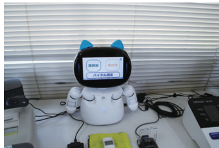
上：アルコールチェック、血圧計、静脈認証、免許証リーダー、体温計と連動し、自動点呼が実現する自動点呼システム 下：ドライバー自身がAI搭載ロボット「Kebbi」を操作して点呼を完了。「タッチするだけだから簡単」（業務終了後のドライバー）
