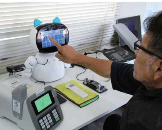
上：アルコールチェック、血圧計、静脈認証、免許証リーダー、体温計と連動し、自動点呼が実現する自動点呼システム 下：ドライバー自身がAI搭載ロボット「Kebbi」を操作して点呼を完了。「タッチするだけだから簡単」（業務終了後のドライバー）
