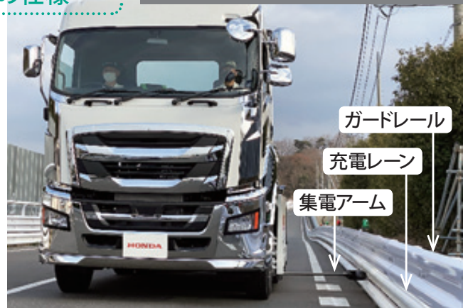
"接触"式走行中給電の充電の様子
