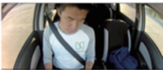
ドライバーの運転挙動をモニタリング。わき見などの危険リスクを検出し、警告音を鳴らすと共にクラウドへ自動送信。
