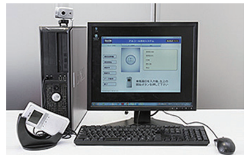
④ IT機器を活用した遠隔地で行う点呼に使用する 携帯型アルコール検知器(タニタFC-1000の設置型の使用例) 出典：(株)タニタHP
