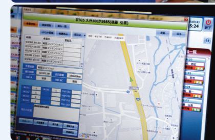
通信式EMSの管理画面。リアルタイムで車両の位置やさまざまな情報をチェックできる
