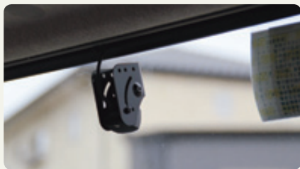
運行データがすべてリアルタイムに送信される最新型。ドラレコの映像はメモリーカードを使用
