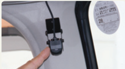
車内に搭載されているカメラは、前方を撮影するもの(上)とドライバーの表情を記録するもの(下)の2台
