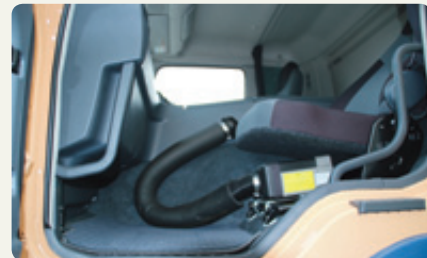
寒冷地である福島という地域に即したアイドリングストップ対策として「ペバストヒーター」を県の助成金を活用し、新車2台に導入
