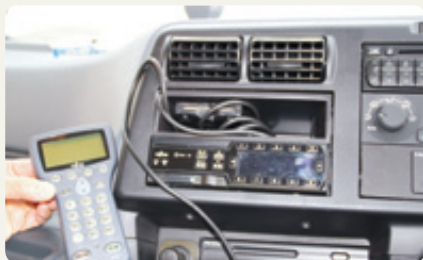
運行データがすべてリアルタイムに送信される最新型。ドラレコの映像はメモリーカードを使用
