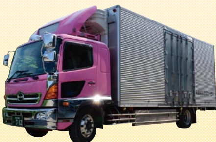
▶ 温度管理機能とエアサスを備えた花卉輸送用トラック
