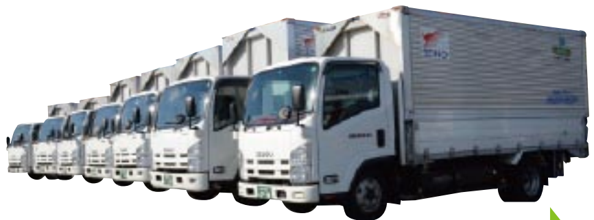
西濃運輸の小口配送に使われているCNG車(2トン・ウイング付きドライバン)
