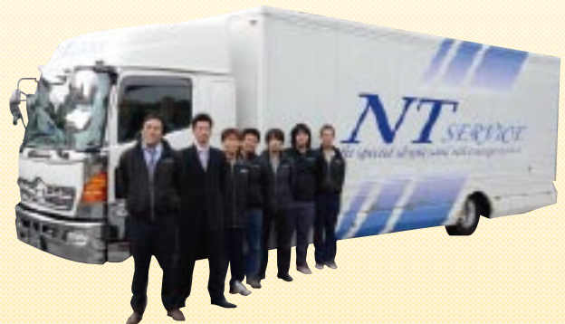
▲ハンガー輸送の主力車両は4トン・エアサス・パワーゲート車
