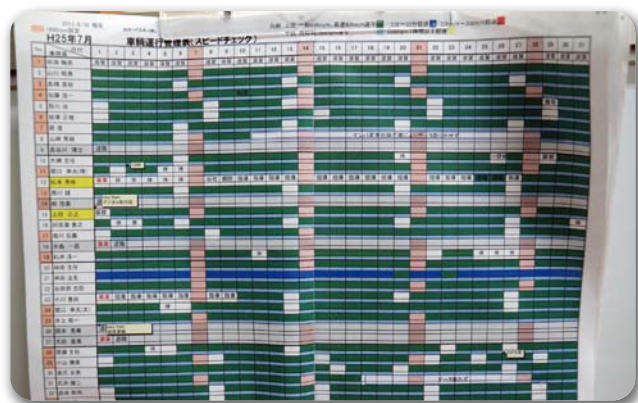
↑事務所に掲示されている車両運行管理表。スピードと回転数の状況を色分けして表示
