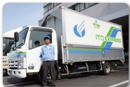
↑近距離の集配に使用されているCNG車
