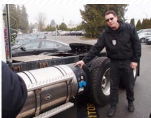
図2 HPDIエンジンに搭載のLNGタンク：タンク容量は、150ガロン(570L) 左右に各々装備
