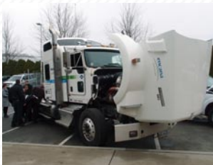
図1 HPDIエンジンを搭載した大型トラック：最高出力は475HP、熱効率は39%
