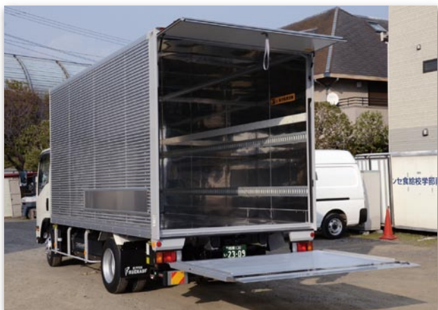
↑全車バン型車両でパワーゲートリフト付き
