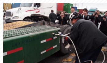
図8 LNGトラックに充填を行うドライバー：保護手袋、マスクを着用して充填作業を行う。
