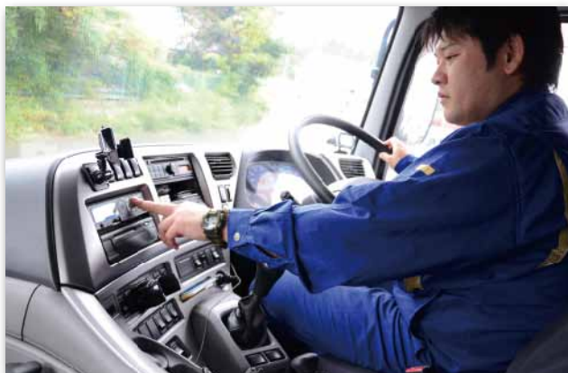
↑デジタコ車載器。ドライバーは「高速」「実車」「積み」「降ろし」のスイッチを押して状態の登録を行う
